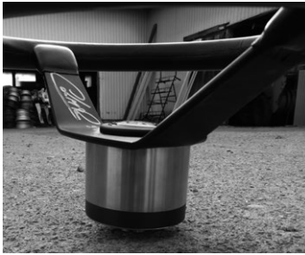
写真1：絶縁体をかまし、三層で仕上げたステアリングボス
