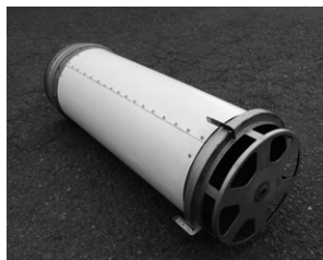
写真4：穴を塞いだ選別ドラム
