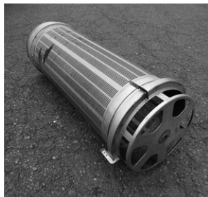
写真1：自動選別計量機の選別ドラム
