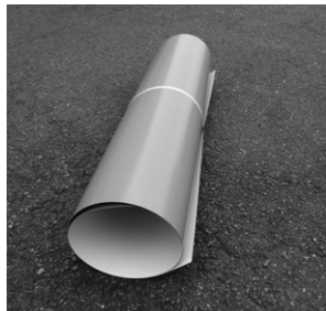
写真2：サビに強くて安い、ガリバリウム鋼板
