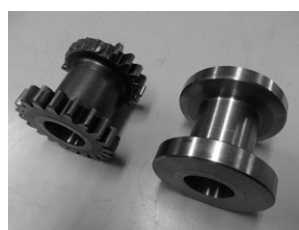
写真1：歯切り工程前のブランク（旋盤加工後）
