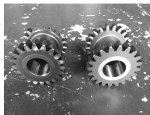
写真2：歯切り・焼入れ・研磨、と加工を進めてギヤ完成
