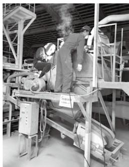
写真1：事前に設計・製作した攪拌スクリュウをオヤジたちが組み立てる様子
