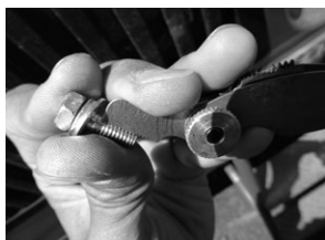
写真3: 使われているネジのピッチまでも必ず計測するの、プロの仕事!!
