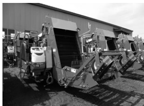
写真1: オートステアリングを装着する訓子府機械工業のオニオンピッカー KTP1200
