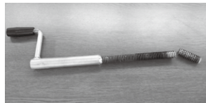
写真2: 台形ネジ部分が折れてしまったハンドル
