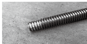
写真3: 端面を旋盤加工した台形ネジ。こうした処理が溶接作業を楽にし、品質を担保する
