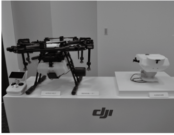
AGRAS MG-1 と障害物回避レーザー（左）、 粒剤散布装置
