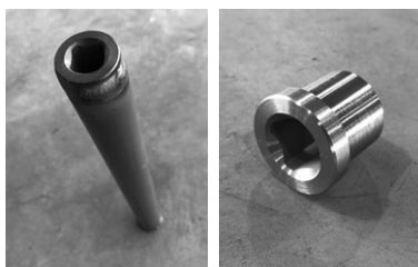
写真4: 製作したパーツを溶接して復活したパイプ
