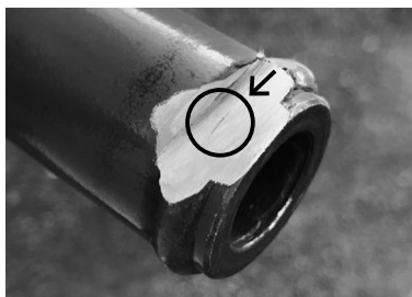
写真2: 「パーツの接ぎ目の線が見えますか?」ここを切断してパーツを取り出す
