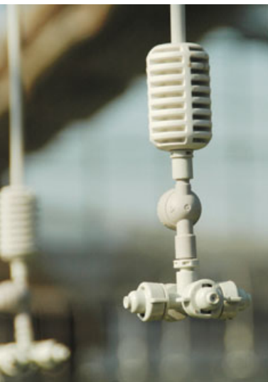
細霧ノズル「クールネット」 63 もネタフィム製。このように會田氏のハウスでは、イスラエルの灌水資材が随所に見られる。電解水との併用効果で散布する農薬の効果は向上し、使用量が減少した。
