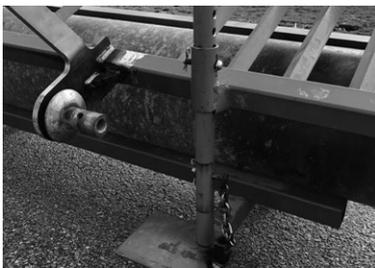
写真3: 転倒防止チェーン&ピンと傾斜調整穴、キャスターを新調
