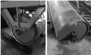
写真2: (右) 溶接部分から割れて磨耗した鉄製ローラー、(左) シンプルかつ頑丈に修復した鉄製ローラー
