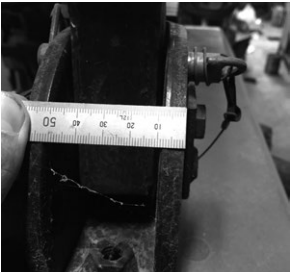
写真2：トラクターの安全フレーム、根元のプランケットは使われていたのは9mm厚。こういう地味な部分も見逃せない！
