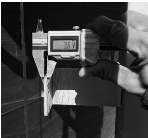
写真3：この野菜収穫機のカバーのステーは3.2mm厚。ノギスが3.6mmを表示しているのはバリと塗装の影響でしょう。感わずに正確に判断すべし！
