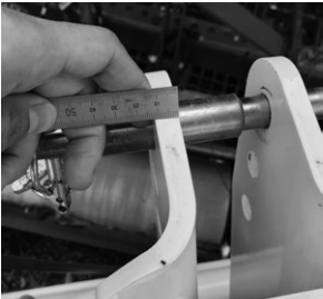
写真1：このプラウのリンク部分のブラケットは12mm厚の板を曲げて作られていた
