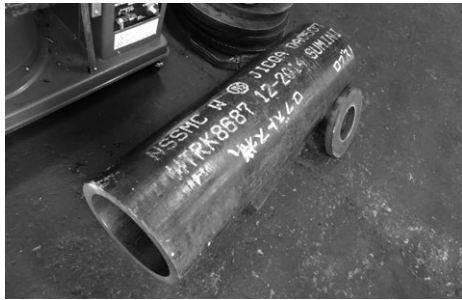
写真1：外径267.4mm×厚さ25mmの丸パイプ
