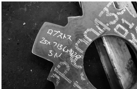
写真2：ガス溶断された厚さ25mmの厚板
