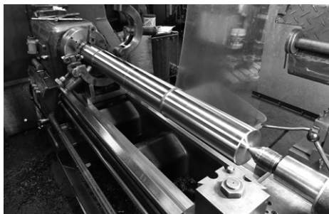
写真3：直径130mmの丸棒の旋盤加工
