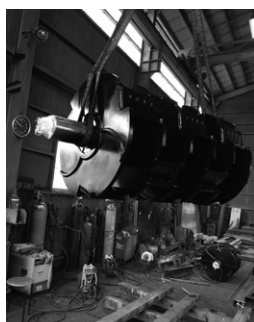
写真5：仕上がった破砕ドラムをホイストで吊り上げ、愛車・三菱キャンターに積んで納品へ
