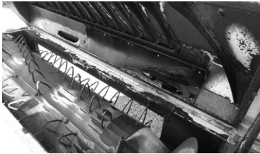
写真2：ボロボロに穴の開いたコンバイン(中セキHC380)の脱穀部
