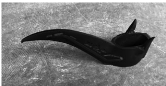
写真3：「使い勝手はとても良いんだけど、曲がってしまうのが不満」というので、両サイドからリブを溶接して強化！ 鍛冶製品は形状がびつな分、手間がかかる
