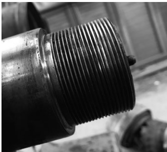
写真2：アルペゴ製のサイドカッターTL33のネジ山。一見生きてるように見えても、このナメ方だとナットは入らない。慎重にネジを立て直して補修完了！
