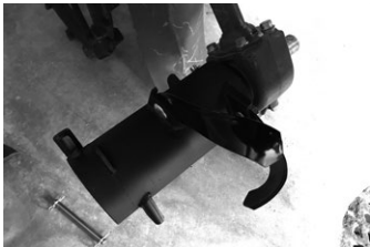
写真1：カルチ用の幅広爪軸は、隙間がギリギリなので機械を使わず金切鋸で切断。内側の切断部分を外側に溶接して完成！
