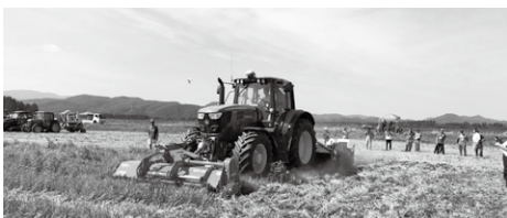
麦稈処理は前後にシュレッダーを装着しての実演。 JD6155 + (フロント) クーンBPR300 + (リア) イマンツ 280
