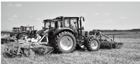
碎土整地は120馬力のトラクターで3m幅の実演。 JD6430PM + (フロント) ダルボ フロントバック + (リア) レムケン ヘリオドール9
