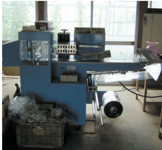
人件費だけでなく、ロールのフィルムを蒸着するこの包装機の導入で、50万袋出荷すれば、フィルム代だけで50万円はコストが下がる。以前は一袋つつ手作業でやっていたが、約280万円の野菜包装機の導入で4人プラス名位の人区で1分で25袋、1日当り3千から4千箱の出荷が可能になった。メーカーは日本ポリスター 65。
