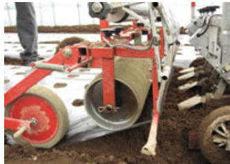
ミスナの播種は、クボタ (総和工業株) の歩行型シーダーマルチ 64。畝立て、点播、穴開きマルチ (幅95cm、4穴) 被覆、鎮圧を一工程で処理する。
