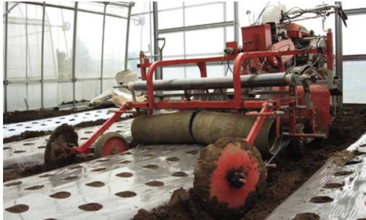
ミスナの播種は、クボタ (総和工業株) の歩行型シーダーマルチ 64。畝立て、点播、穴開きマルチ (幅95cm、4穴) 被覆、鎮圧を一工程で処理する。
