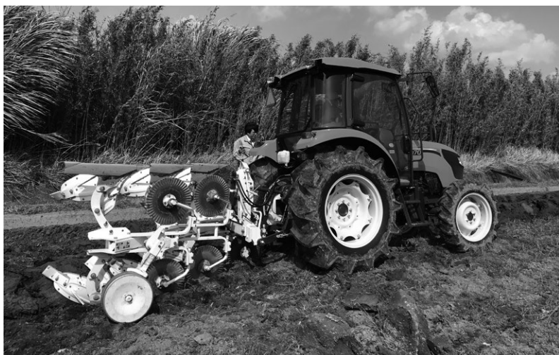
プラウによる深耕・反転（4月9日、中四国クボタによる作業協力）。栽培2年目を終えた山根氏が導入を決めた。来季から作業受託を行なう。
