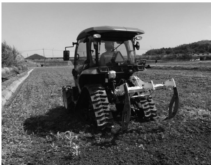
サブソイラによる心土破碎（4月9日）。土づくりの基本作業であるが、山口県内においてはあまり普及していない。
