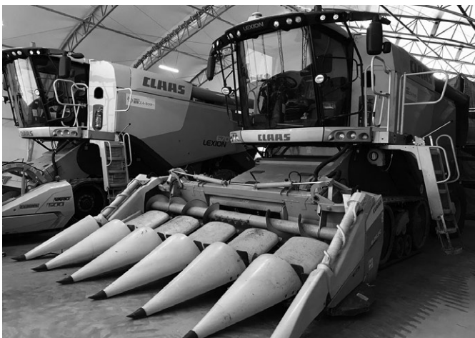
CLAASのコンバインにトウモロコシ収穫用のヘッダーをつけたもの。ヘッダーの左右はそれぞれ折り畳み式になっている(有)岐阜コントラクターの倉庫にて撮影)。
