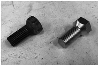
写真4: 複製したH&S-310のテーパボルト(右)。簡単なお目に見える部品でも奥が深い!
