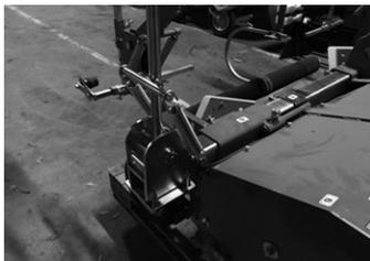
写真3: マーカーは延長した角パイプに組み付け、摺動部品にはステンレス、それ以外は鉄メッキの組み合わせで仕上げた
