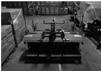
写真2: アグリアタッチ研究所の平高うね可変台形畦整形機VTRN型の両サイドにマーカーを取り付けた
