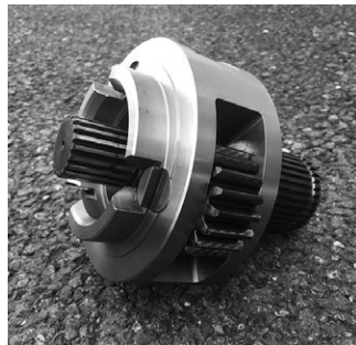
写真1：復元したフロントアクセルスパイダ。この復元作業は本当に大変だったけど、ロボストスはやる！これでシバウトラクターV70Fは復活だ!!
