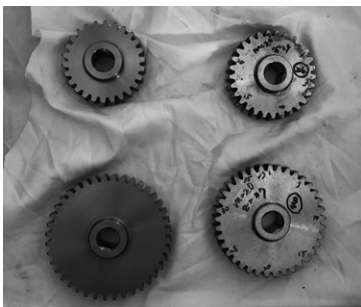
写真1: S木さんの希望どおりにギヤ比1.2倍を狙って仕上げた全自動播種機の播種量調整ギヤ(右)
