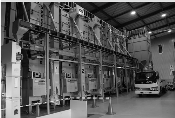
今年2月、盛川農場では将来を見据え、収穫後の作業を効率化するため新たに設備を導入した。これにより移動の時間や労力をかけず、1カ所で粗選、粉碎、フレコンラップへの充てん、ラップ、保管までを行なうことができる。
