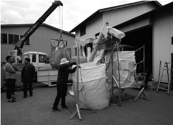
粉碎機からフレコンバッグに充填する作業
