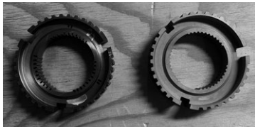
写真4：破損した純正部品に寸法調整を加えたランドクルーザーのクラッチ部分のギヤ。この品質で仕上げられる会社はそうそうないだろう
