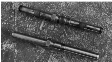
写真1：マルヤマ土壤消毒機のシャフト。両端部は材質が違う部品を圧入している
