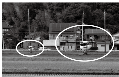
2台のAGRAS MG-1P RTKによる編隊自動航行の様子。一定の高さで一直線に飛行し、散布する薬剤も水面に均一に落ちていた。
