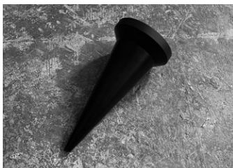
写真3：試しに使ってみた結果、先端部分の形状はこちらに変更した
