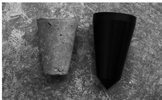
写真2：ポット形状に合わせて、穴あけ器の先端部分を樹脂素材で試作
