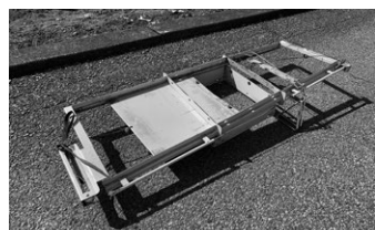
写真2: 破損してしまった粉殻タンクのシャッター (純正品)
