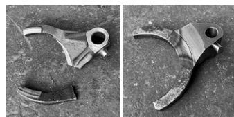
写真3：破損した純正部品のシフターのフォーク（左）と今回製作した複製品（右）。機能を満たすシンプルな形状に変更した結果、純正品より強度も増した。
