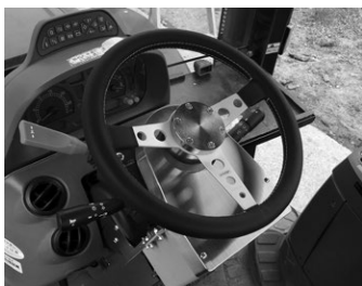
写真3：東京計器製オートステアの 装着例（ニューホランドTS100A）
