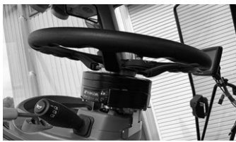
写真1：トプコン製オートステアの 装着例（ジョンディア6430R）
