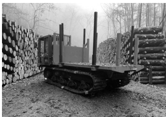
写真2：滑り止めチェーンの装着例②（イワフジ工業フォワーダ、群馬県渋川市にて）
