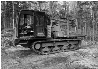
写真1：滑り止めチェーンの装着例①（モロオカフォワーダ、北海道様似町にて）
