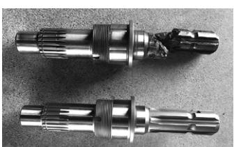
写真4：トラクターのPTOシャフトは朝飯前！ 破損したシャフト（上）と、ほぼ同じ品質で修復したシャフト（下）
