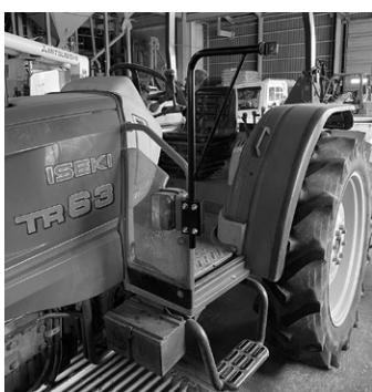
写真3：折れてしまったサイドミラーのフレームは、回転可能なブラケットにしてシンプルに製作！
