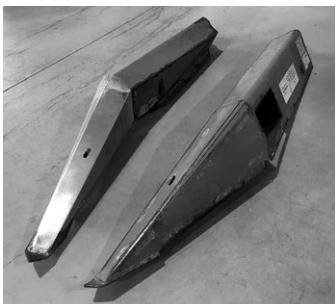
写真2：反対側のカバーから寸法を拾って修復完了！ 形状が複雑だったので、結構難しかった（苦笑）
