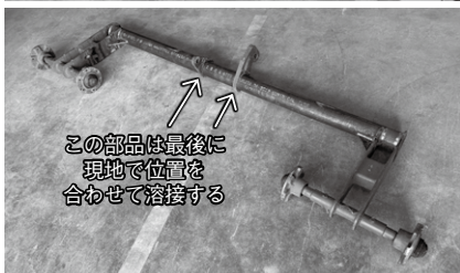
写真3：グニャリと曲ってしまったタイヤ連結フレーム（上）と、部品ごとにバラバラにして使える部品を再利用した修復品（下）。鳥取で溶接してもらって完成!!
