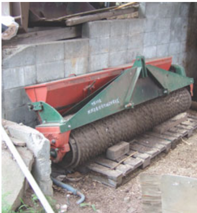
Brillion . 前後に大型のリングローラを持つ播種機。中古で買ったもの。これまでロータリを掛けてこれを使っていたが、今年からはパーチャルハローとの複合作業機にして牧草を播くつもり。鎮圧効果で発芽を良くするとともに、車輪の轍もなくなることを期待している。
