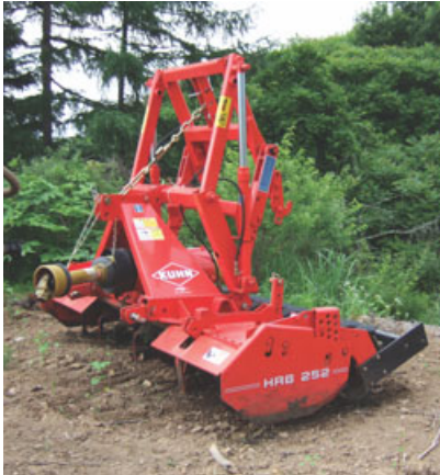
50 クーンパーチャル ハロー-HAB252 (エム・エス・ケー農業機械) 各社のパーチャルハローがあるが、機体後部に播種ユニットを組み合わせる平行四辺形のリンクがあるのでクーンにした。ハローの後部にも鎮圧ローラが付いているが、さらに下の写真の鎮圧ローラ付き播種機を組み合わせる予定。
