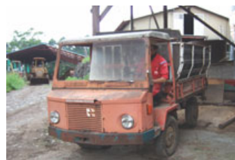
中古機であるが、オーストリア製のファームワゴン (REFORMWRK WELS) を修理してコーンハーベスタの中刈りやサイレージの運搬などに使っている。四輪駆動でPTOが付いており、それでフロアコンベアやマニュアルスプレッド用のピータが動かせるようになっている。フロアコンベアを動かしたり、マニュアルスプレッドとして使うことは無いが、機械好きには持っていることを自慢したくなるような機械だ。
