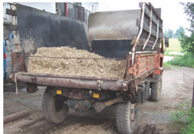
中古機であるが、オーストリア製のファームワゴン (REFORMWRK WELS) を修理してコーンハーベスタの中刈りやサイレージの運搬などに使っている。四輪駆動でPTOが付いており、それでフロアコンベアやマニュアルスプレッド用のピータが動かせるようになっている。フロアコンベアを動かしたり、マニュアルスプレッドとして使うことは無いが、機械好きには持っていることを自慢したくなるような機械だ。
