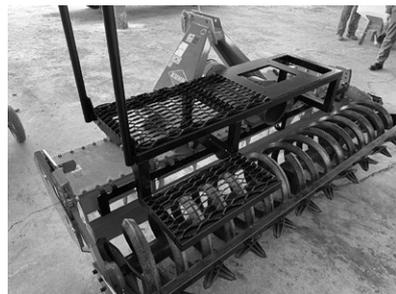
写真1：KUHNのパワーハロー HRB252に装着したシーダー組み付けフレーム。滑りにくいエキスパンドメタルを使って、牧草の種子を置けるようにステップも広くした
