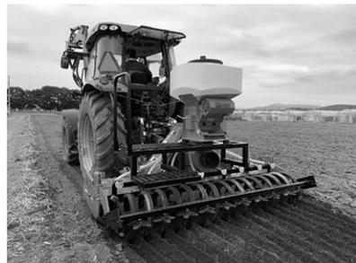
写真2：KUHNのスモールシードドリルを組み付けて、準備OK! 発進! これで、耕起同時播種作業ができる
