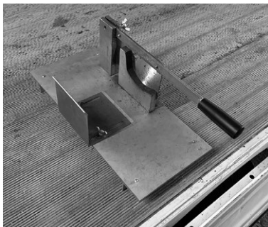
写真2:廃業した鉄工所が製作していた既存のブロッコリー茎切機
