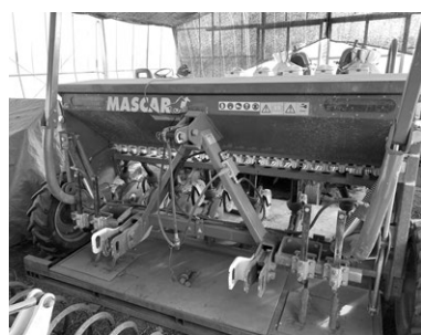
写真1: MASCARのドリルシーダーから油圧マーカークを取り外す。農機のワンオフ対応は、その農場で活用できるアイテムを有効活用するという判断も、短納期&低コストを実現する重要ポイント!
