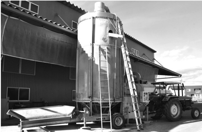
イタリア MECMAR 製モバイルドライヤー STR13 / 119T。13t用。高さ 6.7 m。
