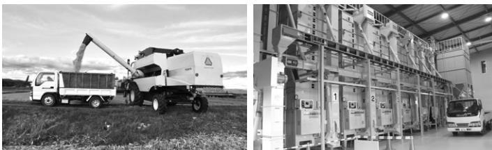
(左) 6条コンバインで収穫作業し、3台のトラックで圃場から運搬。 (右) 屋外のモバイル乾燥機のほか施設内で既存乾燥機6台を使用。
