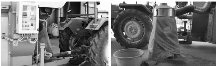
(左) トラクターをモバイル乾燥機に連結して動力を供給。 (右) タンクからトウモロコシの子実の芯などのゴミが排出される。
