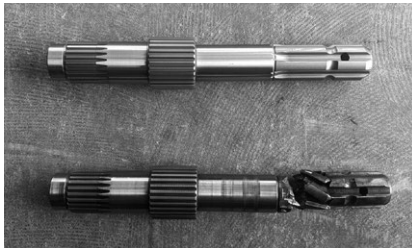
写真1：ヤンマー YM7000DのPTOシャフト。ご依頼が多い部品なので、いまや朝飯前！
