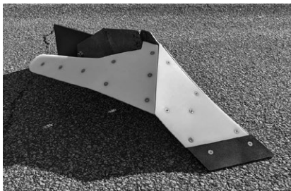
写真3：その昔、地域の鉄工所が作っていたヤマトイモ掘取ディガーをチューンアップ。樹脂板の切り抜きも手抜きはしないぞ！
