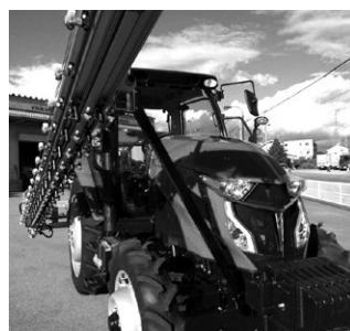
写真4：ヤンマーYT5113仕様は販社の要望で、フロントウエイトに挟み込む仕様で製作
