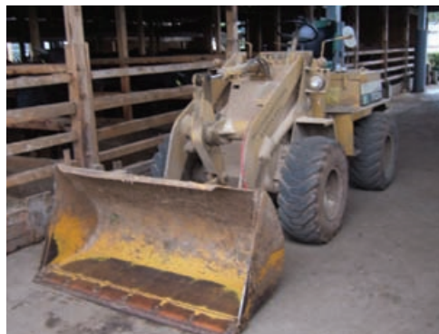
やはり中古で買った0.4mの機体中央で胴体屈曲するホイールローダ（TCM808）。狭い畜舎での作業に最適
