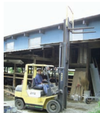
3段マストのリフト（2.5t）。中古のTCMだが、4.3mまで上がる
