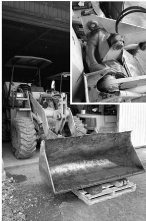
写真1：バケットが上がらなくなったホイールローダTCM815。がっつりフレームが変形しているので、修復はかなり難しい
