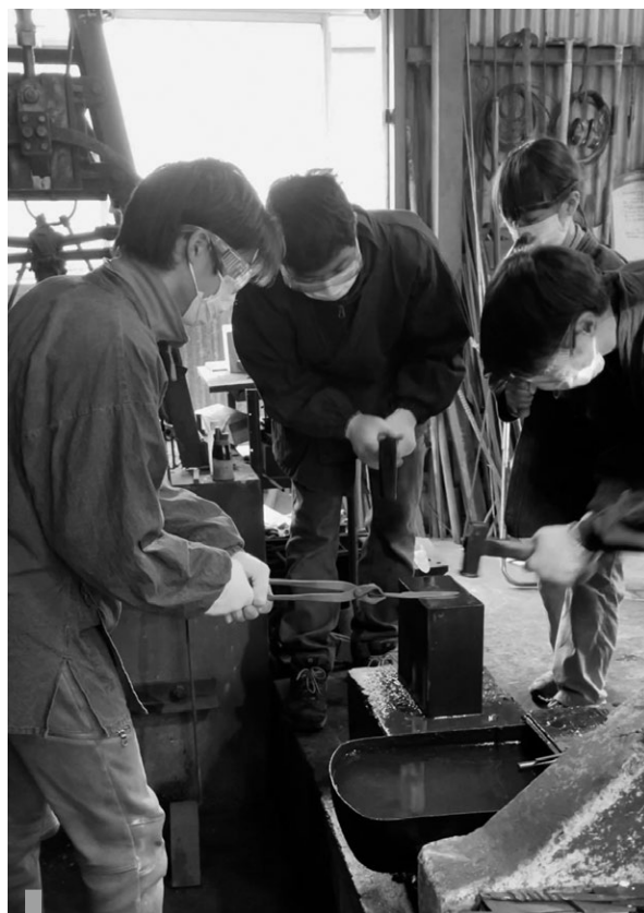
真っ赤になった鋼材を叩くことだけで 包丁の形にしていきます。
