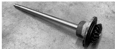
写真3：溶接でツギハギになり破断していた駆動シャフトも、硬い鋼材に変えて新たに製作した
