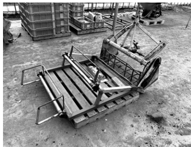
写真1：かつて地域の鉄工所が作ったマルチ巻取り機。シンプルで使い勝手はとも良いらしいが、駆動部品はガタガタでローラチェーンが外れてしまう状態に
