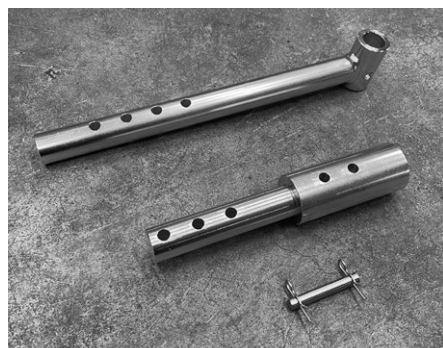
写真3：キセキPVH100のカスタマイズ部品。丸棒に穴を開けただけの即席のロットピンもプレゼント。シンプルな仕事を黙々と積み上げよう！
