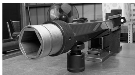
写真2：ヤンマーPH1WAのカスタマイズ部品の1つ。純正部品を活かして追加工で仕上げることで、コストを抑えて納期を短縮した
