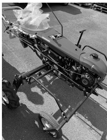
写真1：センター植え仕様にカスタマイズしたヤンマーの野菜移植機PH1WA
