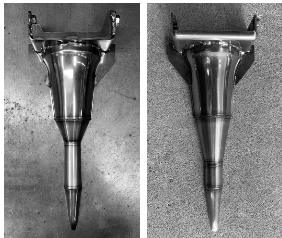
写真3：カスタマイズしたホッパー。3パターン試作して、Ver.3(左写真)で納得いく結果が得られた。もう少し円錐角度を緩やかにしたいところ
