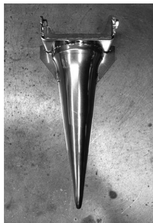
写真1：中セキ半自動野菜移植機PVH2のホッパー
