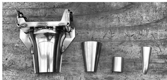
写真2：ホッパーをサンダーで大胆に切断してバラバラに。今回のカスタマイズでは、純正品の根本と先端を活用した
