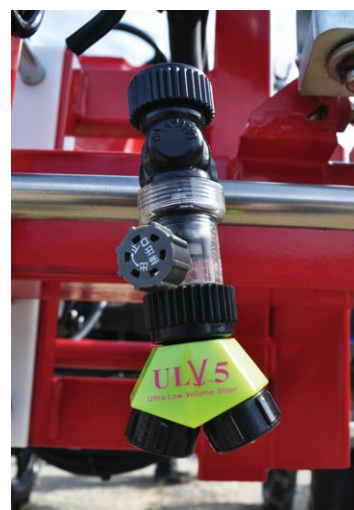
写真1: 散布水量5ℓ/10aという少量散布を実現するラウンドノズルULV5
