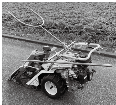
写真4：サブちゃんの「リアット」を機械化すべく、バインダーの前方と左側に位置調整可能なガードを製作した。ちょっとした工夫で快適な収穫作業が実現だ！
