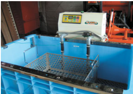
▲60℃のお湯で8~10分殺菌する。島田さんは最近、(株)タイガーカワシマの「湯芽工房」を農業の使用量を減らす目的で導入した。主に地域の環境に配慮していることだが、償却が済めば農業代が減る分、コスト減にもなる。
