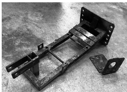
写真2：ボロボロに錆びて折れてしまったフレーム。この状態から寸法を丁寧に拾う
