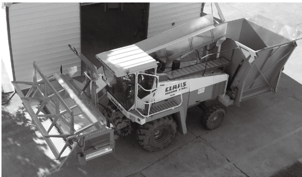
図2：Herbas社のヘンプ収穫用コンバイン
