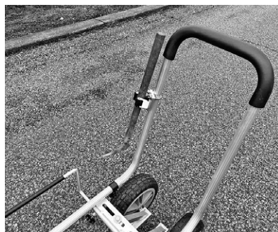
写真4：鎌ホルダーも手を抜かず！ 作業者がそれぞれ高さや方向など取付位置を調整できるように配慮してつくった
